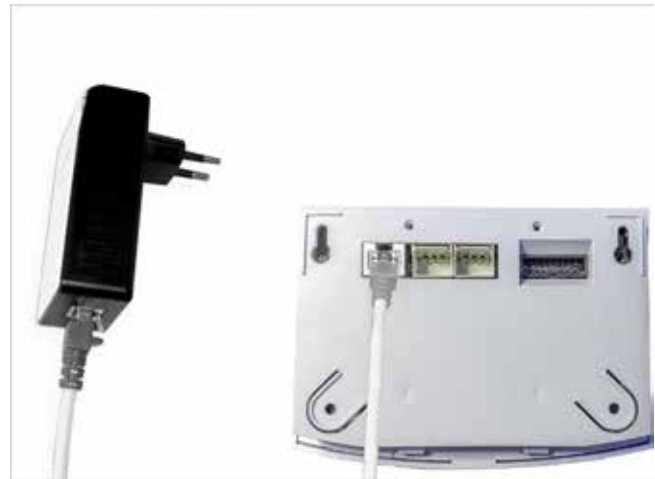
Abb. 12: PowerLine-Adapter mit SolvisControl 3 verbinden
