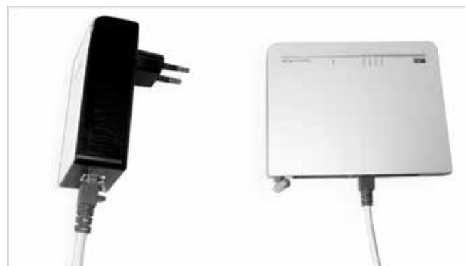
Abb. 13: PowerLine-Adapter mit Router verbinden
